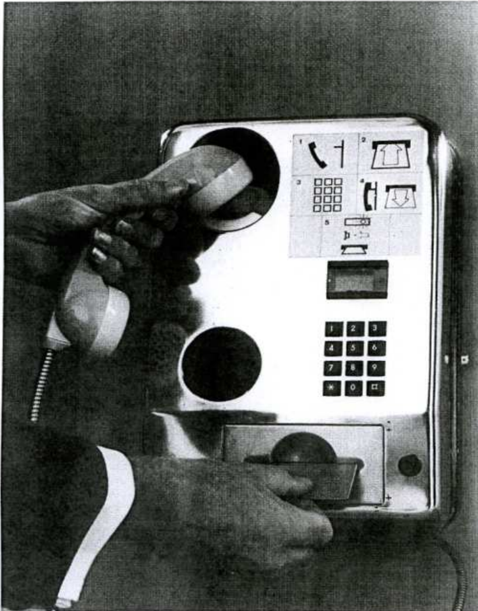
Bild 6 Telefonieren mit PHONOCARD - Eingabe der Karte
