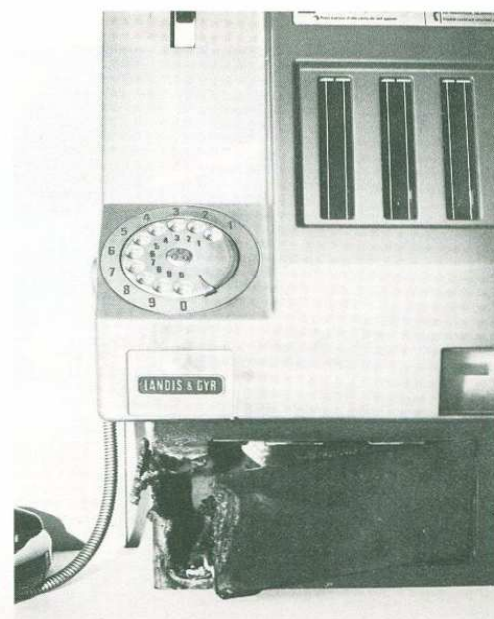
Bild 4 Dieser aufgebrochene Münzfernsprecher ist ein Beispiel für die oft unverhältnismässig grossen Mittel, die angewandt werden, um an die Münzkassette zu gelangen.
