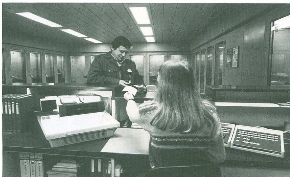
Bild 5 Der Betrieb von bedienten Sprechzellen erfüllt die Anforderungen nach hoher Sicherheit und Benutzerkomfort weitge- hend. Die Fernsprecher sind mit einer Gesprächsdatenerfassungsanlage verbunden und der Benutzer erhält bei der Be- zahlung der Verbindung einen Belegsdruck. Diese Anlage ist jedoch nur bei hoher Gesprächsdichte wirtschaftlich. Ununterbrochener Betrieb ist wegen des hohen Personalaufwandes kaum denkbar.
