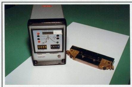
510.8 Control device for die cutting cycle / Dispositif de contrôle pour cycle de matriçage
