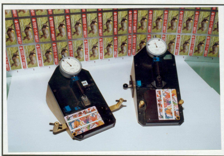
320.3 Device for the checking of card dimensions / Dispositif pour contrôler les dimensions des cartes
