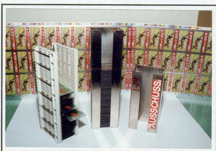
341.6 Synthetic material loader for 60 cards / Chargeur en matière synthétique pour 60 cartes 341.7 Metal loader for 200 cards / Chargeur métallique pour 200 cartes 341.8 Metal loader for 400 cards / Chargeur métallique pour 400 cartes
