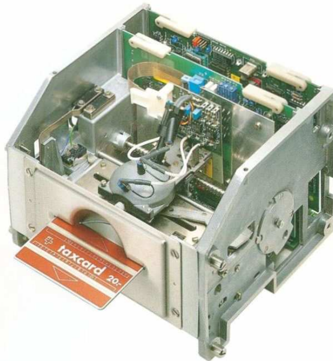
▲ Der Kartenleser liest und entwertet die optische Codierung auf der Wertkarte – Einheit um Einheit
